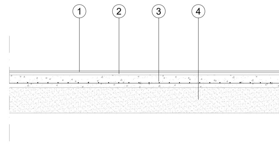
1. Tratamiento endurecedor de pavimento continuo de hormigón, con pintura de protección epoxi con un espesor máximo de 0.25 mm.
