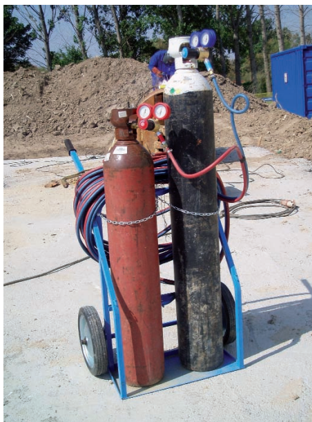
Equipo de soldadura y oxicorte.
