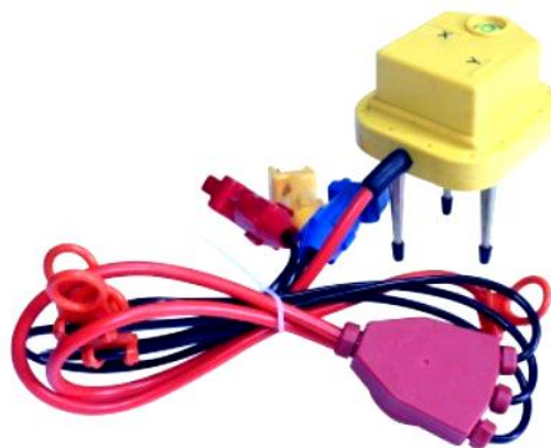
Figura 13: Geófono triaxial de 4.5Hz
