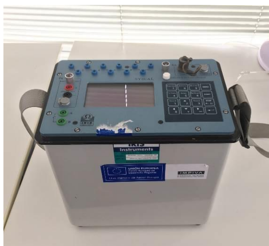
Figura 14: Resistivímetro SYSCAL IRIS PRO SWITCH 48.
