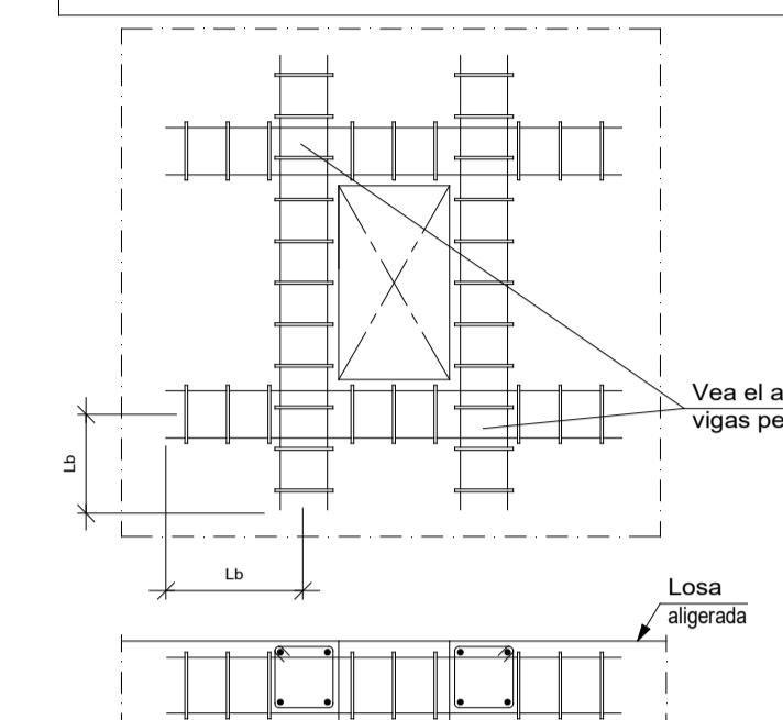
Refuerzo de hueco no previsto en losa aligerada.
