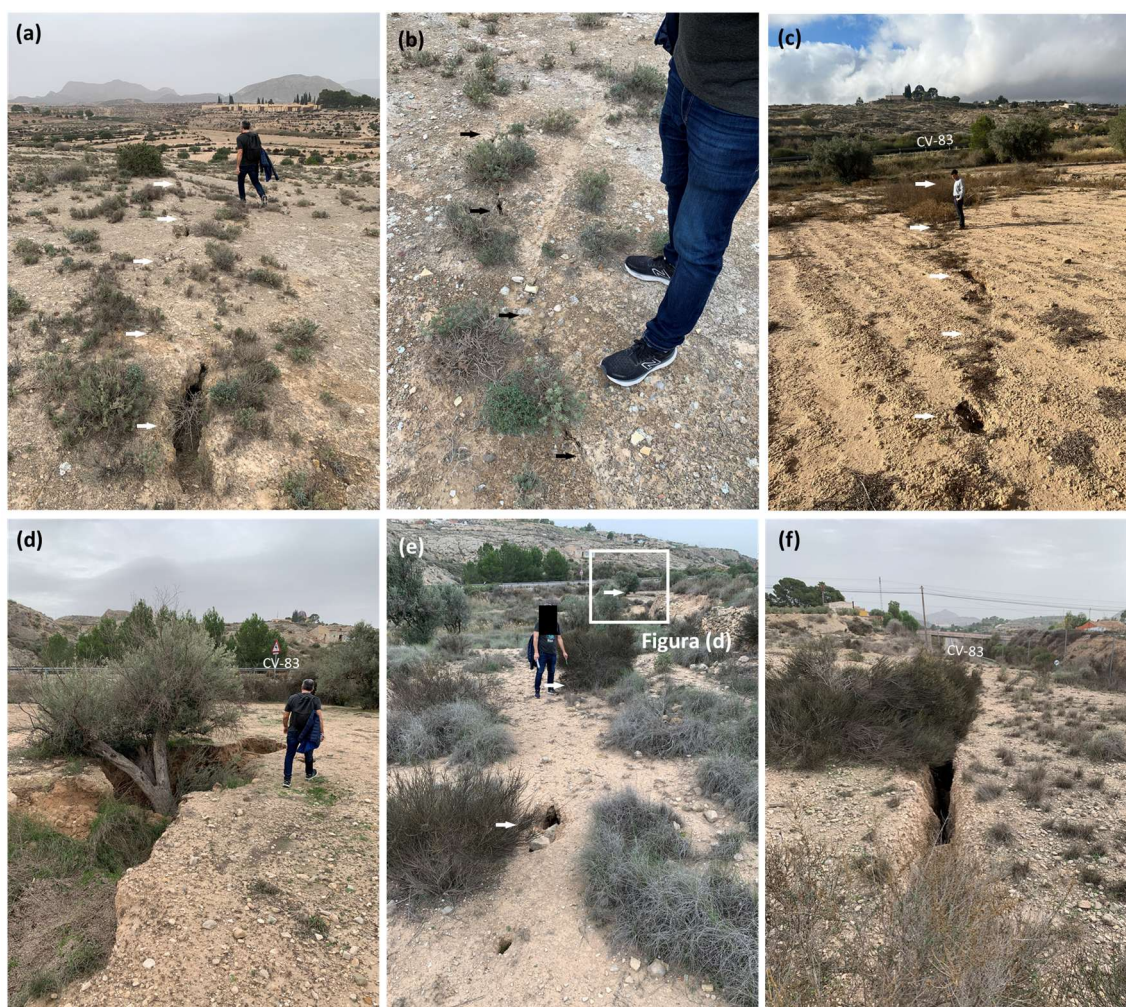
Figura 13. Grietas en el terreno: a) Grieta de orientación aproximada N-S y de reducida apertura situada en la zona de Els Clots. b) Grieta incipiente de escasa persistencia y apertura (Els Clots). c) Grieta situada en un banal de olivos junto a la CV-83 parcialmente cubierta de vegetación. d) Grieta de grandes dimensiones parcialmente erosionada situada en un banal de olivos situado junto a la CV-83. e) Prolongación hacia el norte o de la grieta mostrada en figura d). f) Grieta de gran persistencia, apertura y profundidad desarrollada en un depósito de terraza cementado junto a la CV-83.
